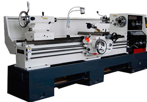
Torno Convencional: diámetro máximo 400 x 3.000mm de largo
