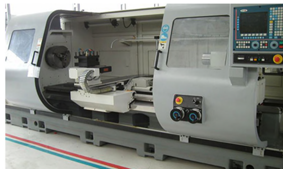
Torno Control Numérico Chevalier: diámetro máximo 650 x 3.000mm de largo
